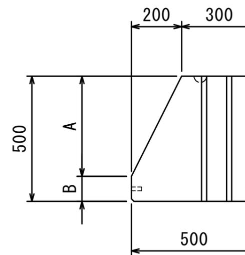
D型基礎ブロックの寸法・質量・中込容積表
